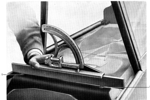
Abb. 6: Justiermarken für die Querwage
